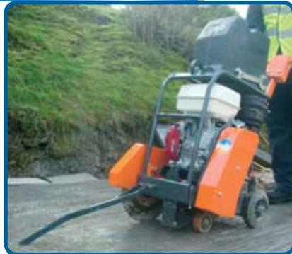
**Talni rezalnik 350mm**
