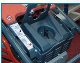
S standardnim trojnim filtrom zraka
